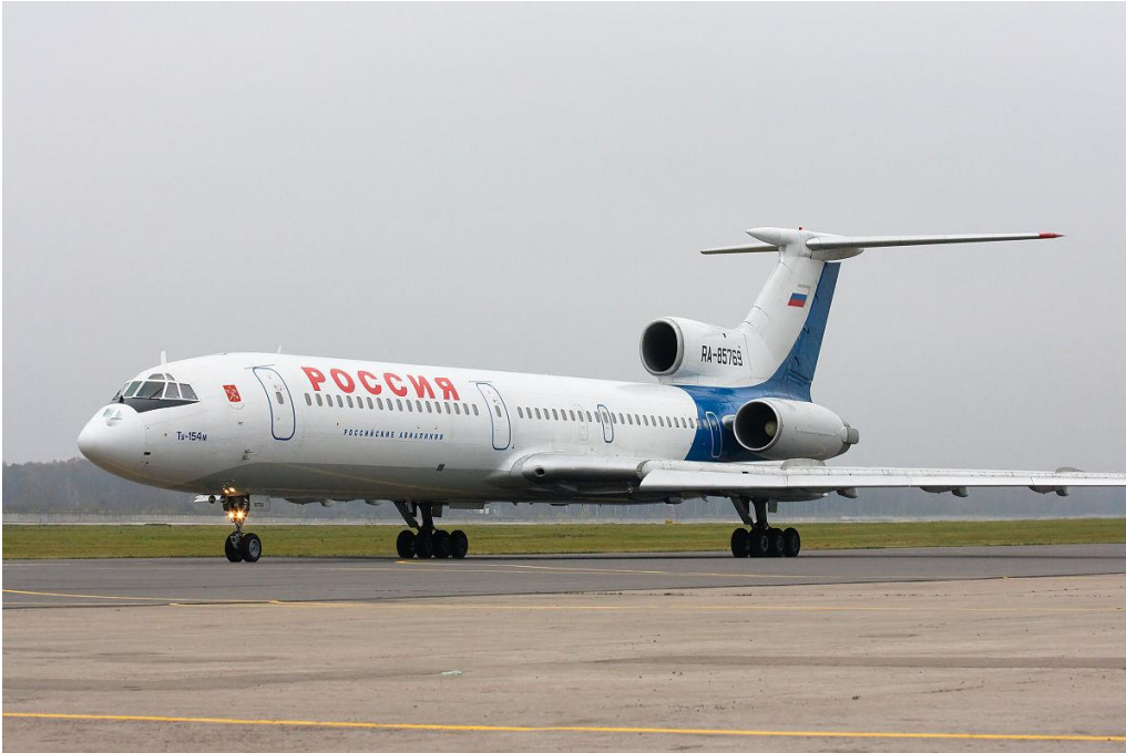
Trireactor Tu 154, en la foto se aprecia su tren de aterrizaje principal con múltiples ruedas
